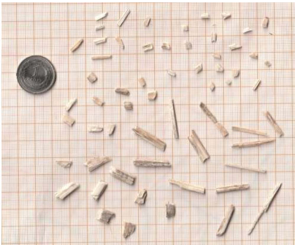
Rysunek 4. Nieregularność kształtu paździerzy konopnych zastosowanych w programie badawczym.
