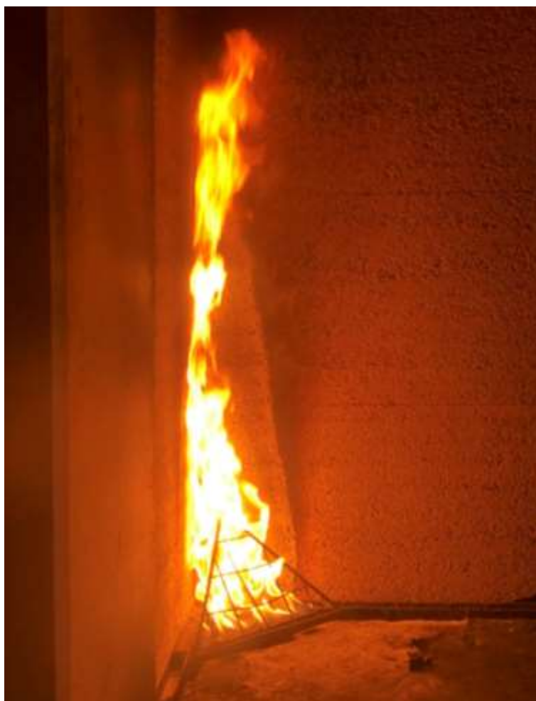
Rysunek 10. Badanie reakcji na ogień (zdjęcie autora).
